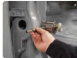
Inserire lo strumento di misurazione BOR-ON nel supporto e iniziare il test
